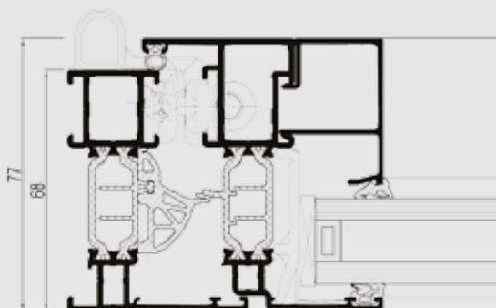
Concept System® 77 è il sistema Reynaers a taglio termico a 3 camere per porte e finestre che combina elevate prestazioni di isolamento termico con gli alti livelli di comfort, stabilità e sicurezza.
